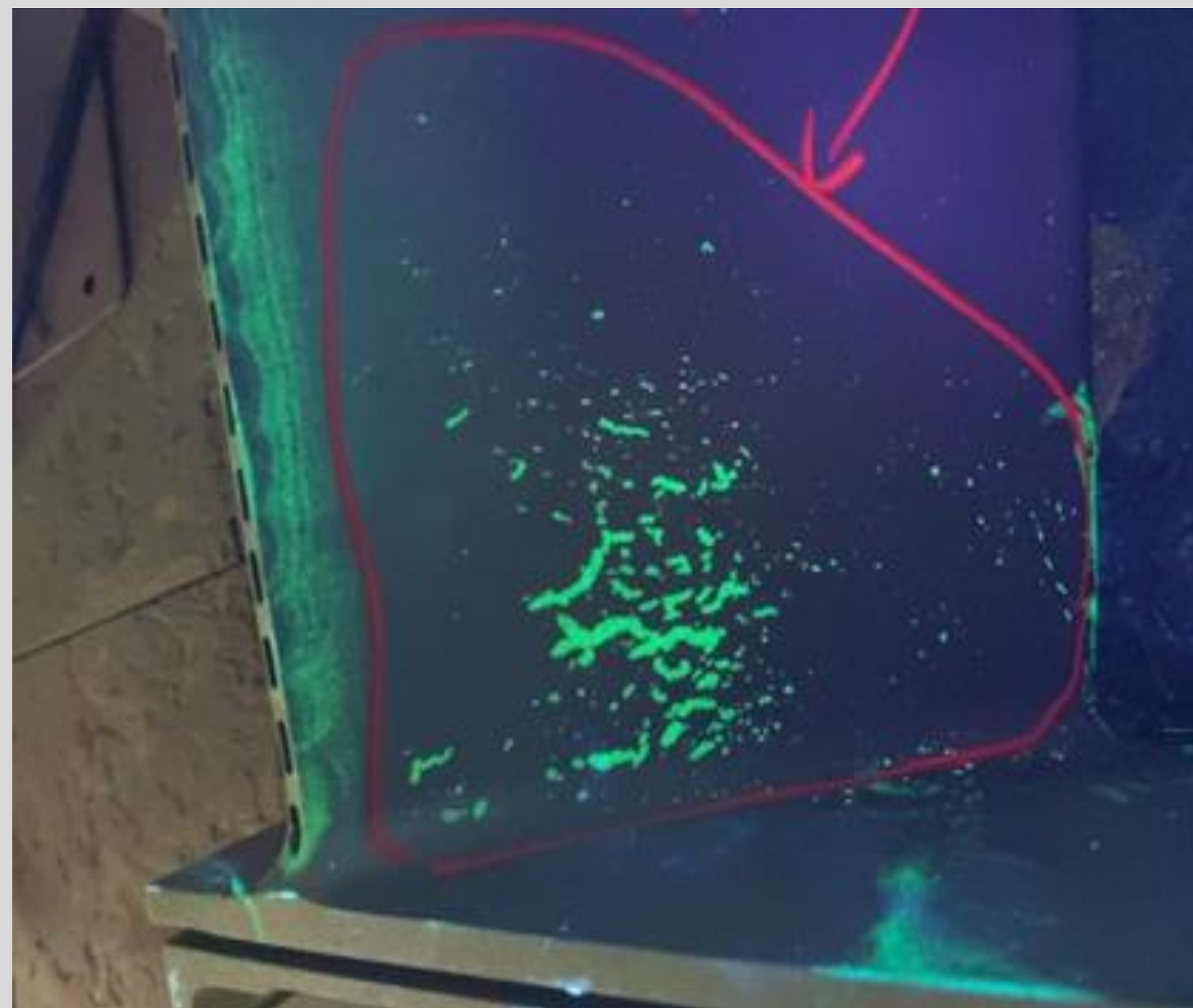
شکل ۳- ترک های شبکه ای روی سطح ایرفویل پره ثابت
