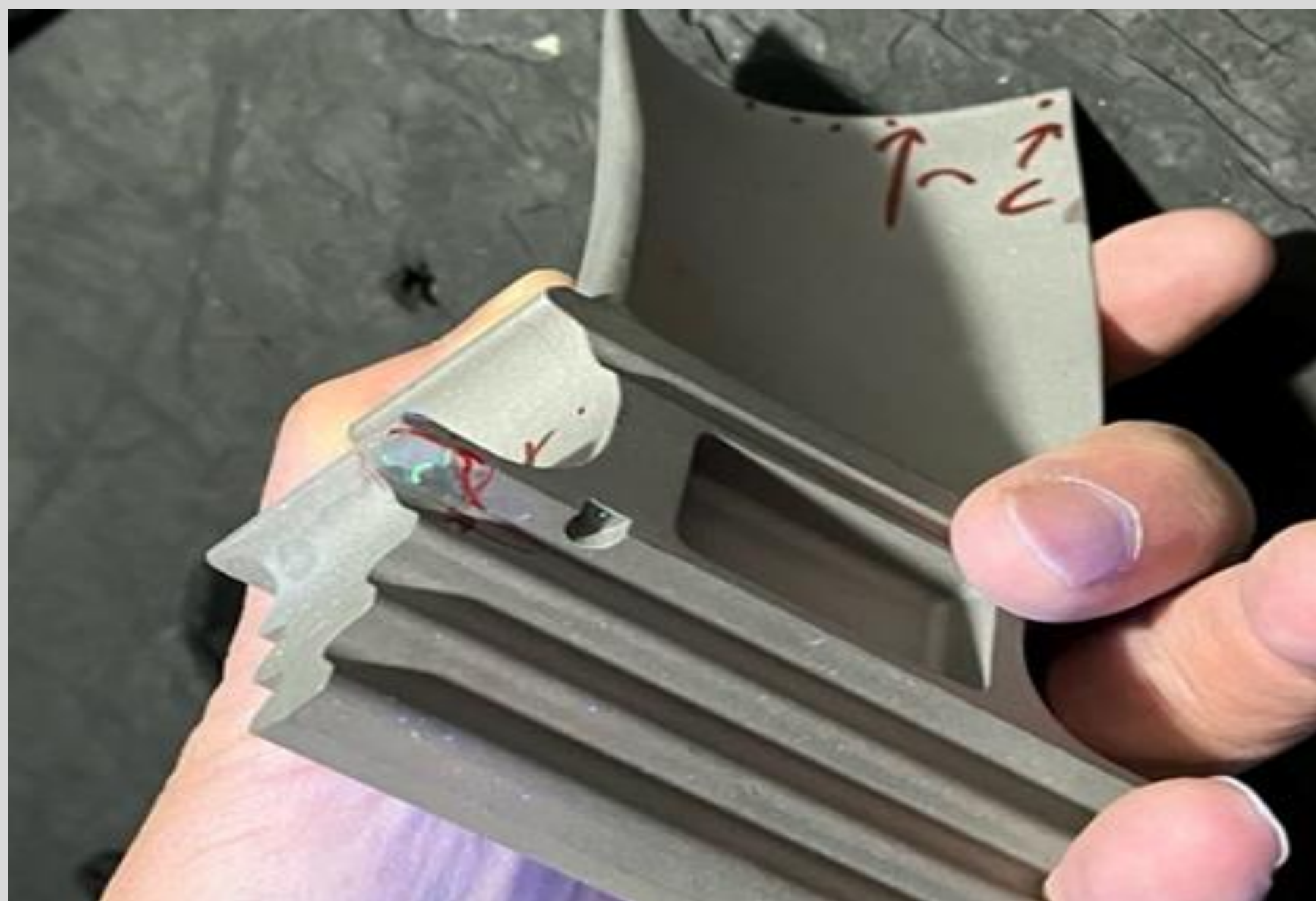
شکل ۲- ترک‌های مشاهده شده در نواحی جوشکاری شده پس از بهره‌برداری
